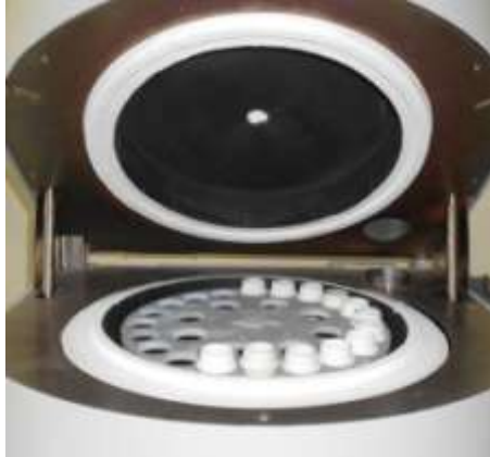
Memasukkan crusible ke dalam alat TGA
