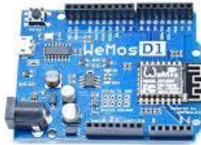
Gambar 2.3 Modul Wemos D1 ESP 8266 (sumber: Dokumentasi Penulis)
