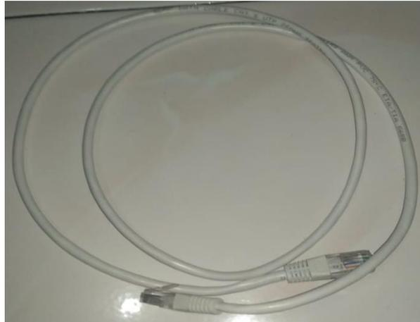
**Gambar 2.10 Kabel UTP LAN**
