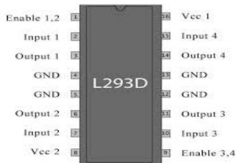
Gambar 2.5 Konstruksi Pin IC L293D
