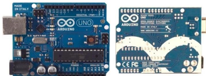
**Gambar 2.9** Arduino UNO<sup>[3]</sup>
