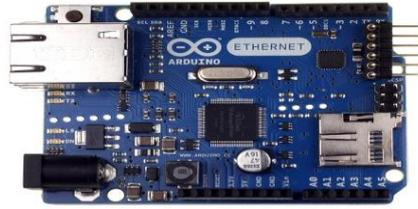
**Gambar 2.18** Arduino *Ethernet*<sup>[3]</sup>
