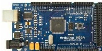
Gambar 2.11 Arduino Mega<sup>[3]</sup>
