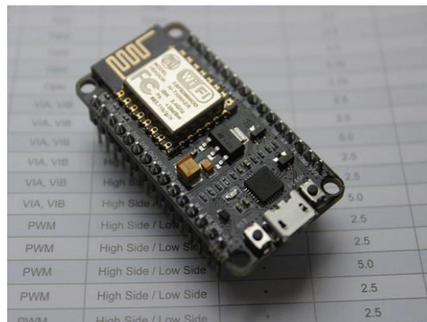
Gambar 2.4 NodeMCU generasi kedua / board v.1.0 (v2)[12]
