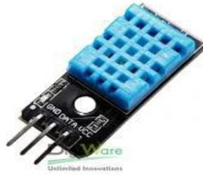
**Gambar 2.5** Sensor Suhu dht-11[18]
