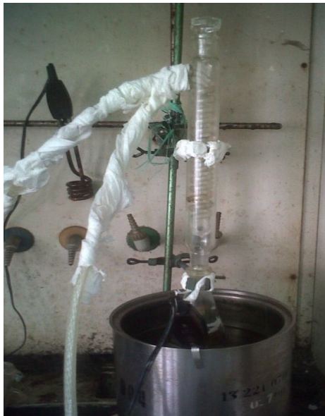
(q). Proses Refluks Penyabunan
