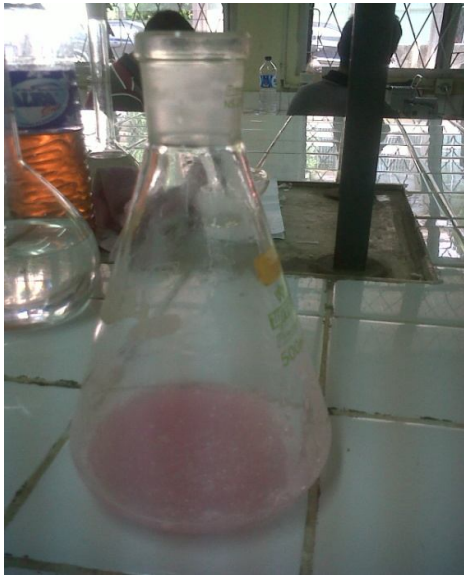
(s). Sebelum dititrasi + indicator PP ditetesi
