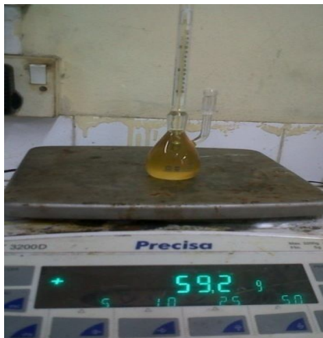
(c). Pengecekan Densitas Sebelum Pemurnian
