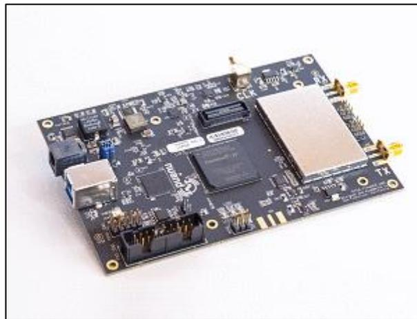
Gambar 2.7. Perangkat SDR Nuand BladeRF x40
