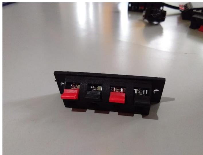
Gambar 2.15 Konektor Kabel
