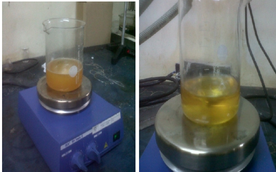
Gambar 23. Proses Evaporasi atau pemanasan yang dilakukan \pm 1 jam dengan suhu 50^{\circ}\text{C}
