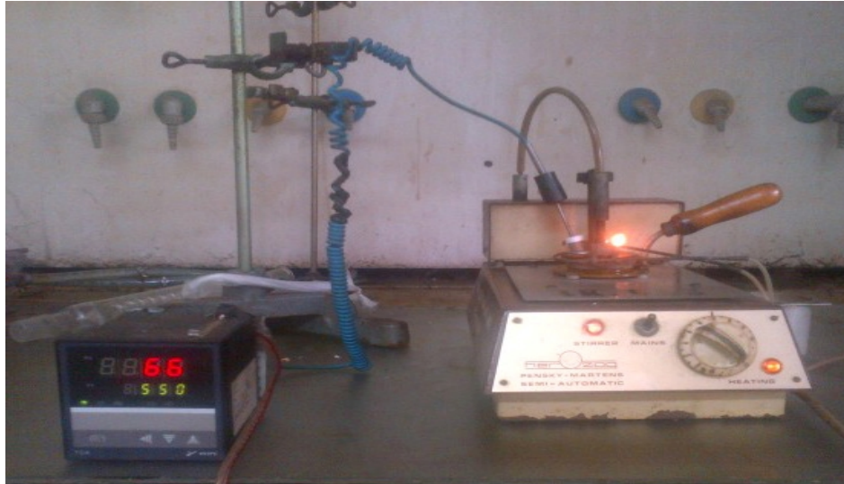
Gambar 29. Pengukuran Titik Nyala
