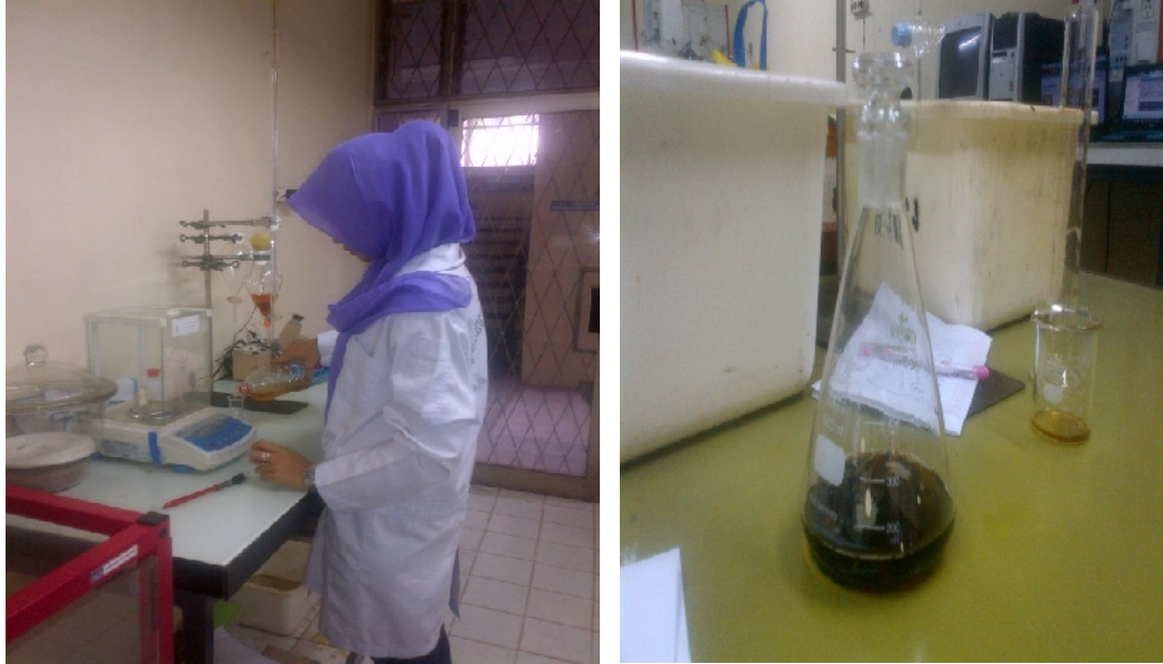
Gambar 18. Menimbang sampel dan menggabungkan bahan (minyak jelantah, cangkang kelapa sawit, methanol, serta abu menjadi satu).
