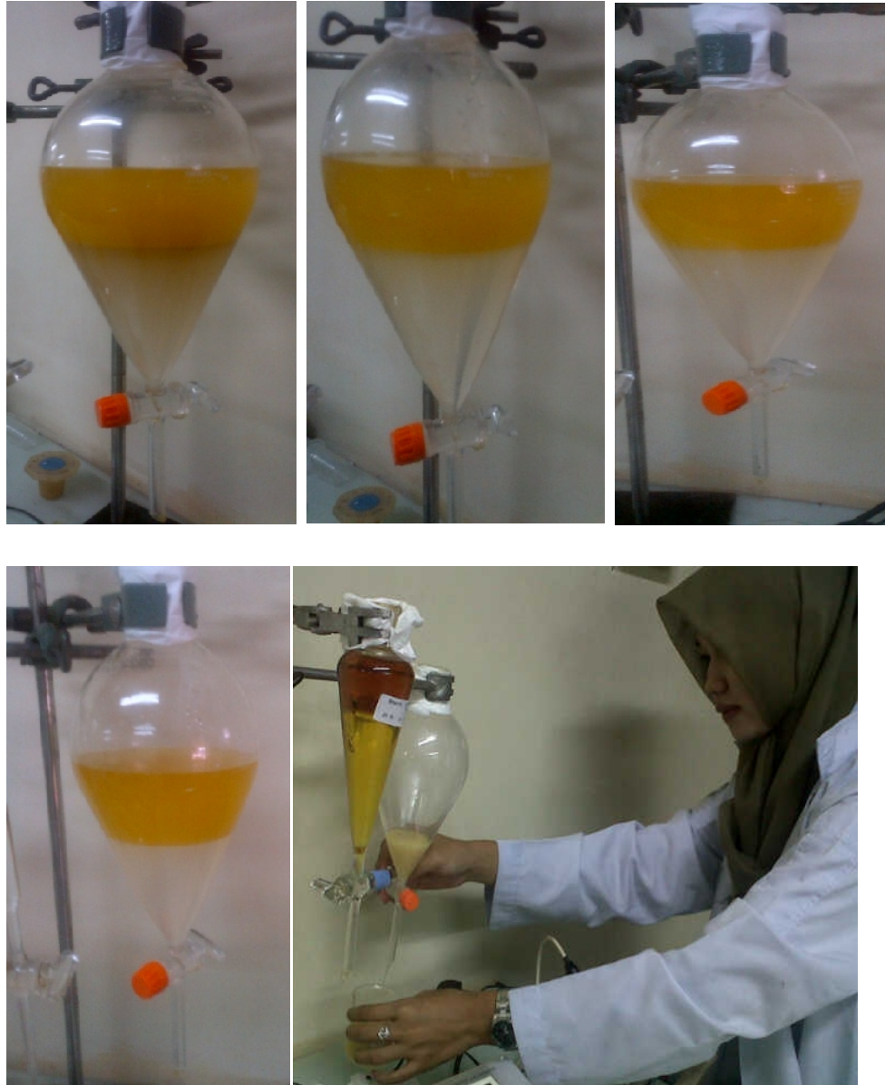
Gambar 22. Proses pencucian biodiesel menggunakan air hangat sebanyak 5 kali pencucian
