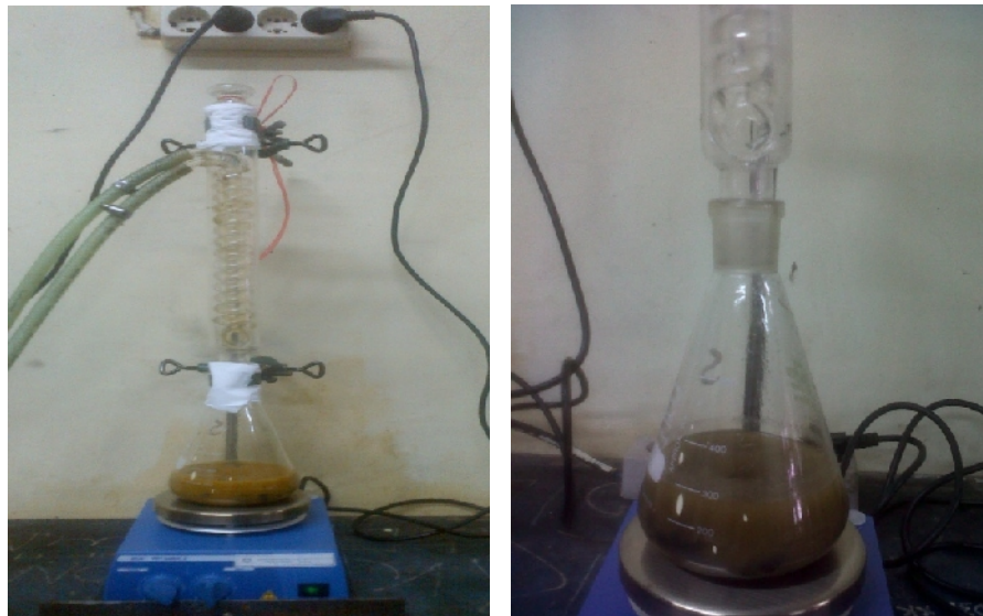
Gambar 19. Proses Transesterifikasi in situ yang berlangsung pada suhu 60^{\circ}\text{C} dan waktu 60 menit. Diaduk dengan kecepatan rata-rata \pm 200 rpm.
