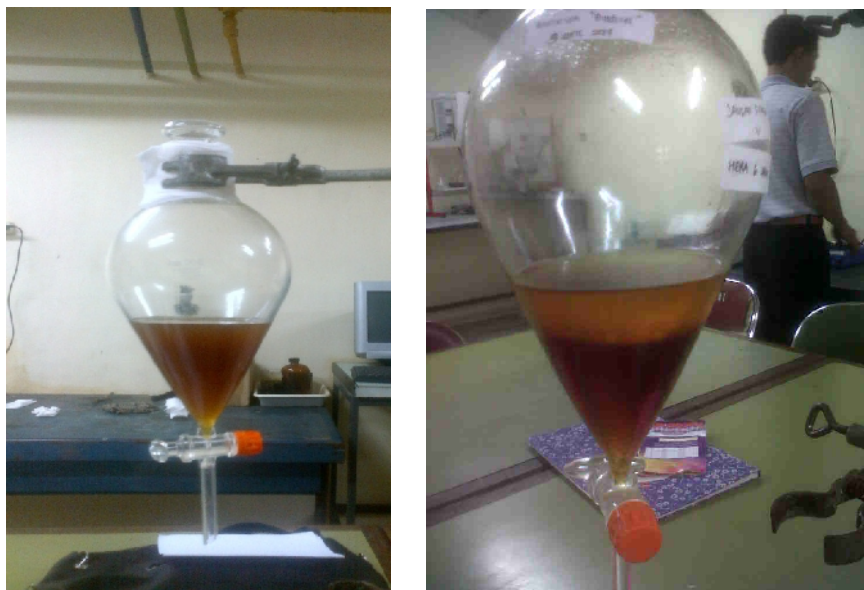
Gambar 21. Proses Pemisahan antara metil ester (biodiesel) lapisan atas dengan gliserol lapisan bawah
