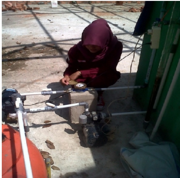
Gambar 36. Mengecek kecepatan laju alir pada proses sirkulasi
