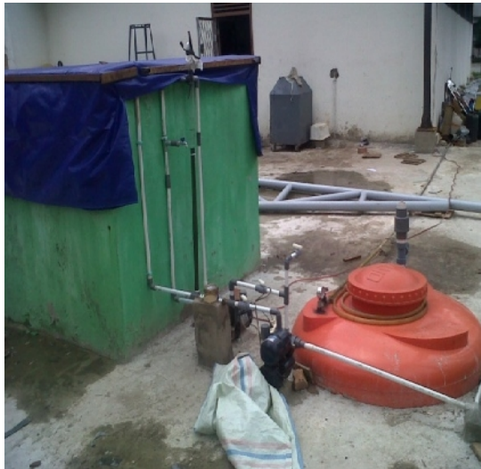
gambar 24. reaktor hidrolisis flowmeter dan metanogenesis .
