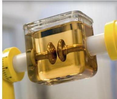
**Gambar 2.6** Minyak Isolasi Trafo Tenaga
