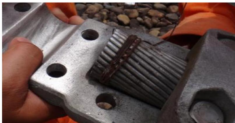
Gambar 2.8 Permukaan yang Tidak Rata Karena Adanya Ikatan Kabel<sup>2</sup>
