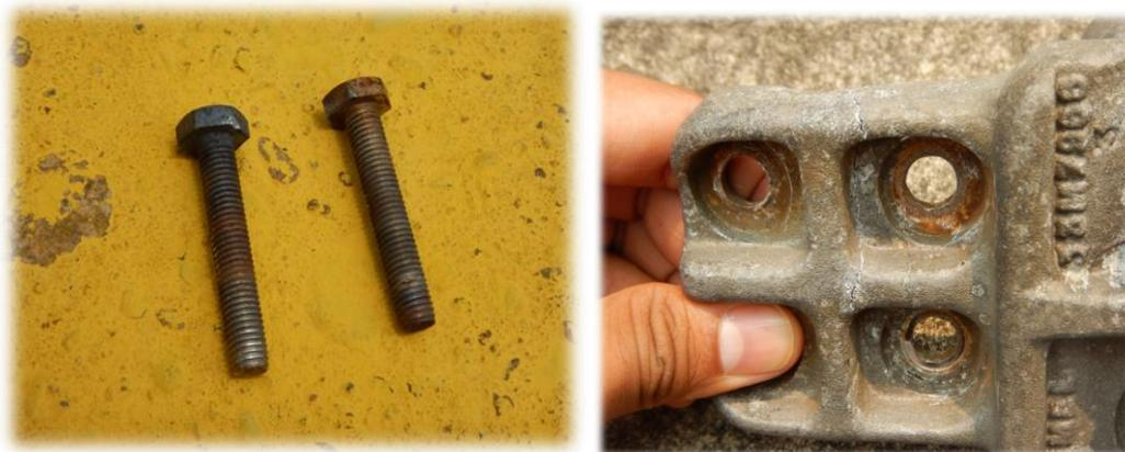
Gambar 2.10 Adanya Karat pada Klem dan Mur Baut Peralatan di *Switchyard*<sup>2</sup>
