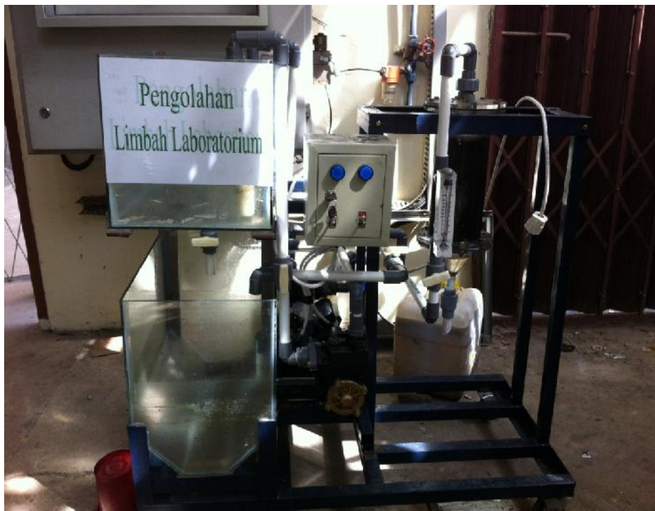
Gambar 1. Rangkaian alat pengolahan limbah cair laboratorium
