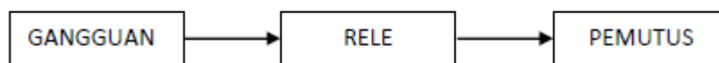
Gambar 2.9 Diagram Blok Urutan Kerja Relai Pengaman (Sumber : Teknik Transmisi Tenaga Listrik Jilid 3 hlm.373)
