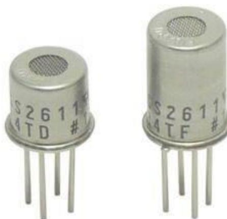
Gambar 2.10 Sensor Tgs 2611[26]
