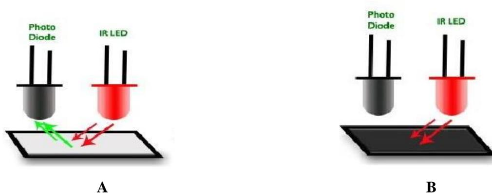
**Gambar 2.7 Aplikasi sensor photodiode [5]**
