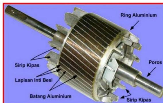
Gambar 2.6. Gambar Rotor Sangkar
