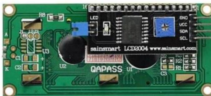
Gambar 2.16 LCD 16x2 tampak belakang dengan modul I2C<sup>[14]</sup>
