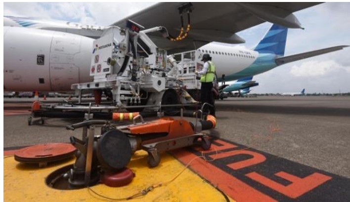
Gambar 2.22 Pengisian Bahan Bakar dengan Fuel Hydrant
