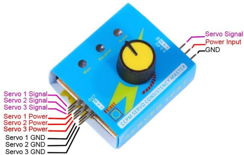
Gambar 2. 33 konfigurasi pin ccpm servo tester
