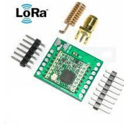
**Gambar 2.4** RFM9x LoRa module 915MHz
