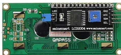
**Gambar 2.9** Liquid Crystal Display 16x2 dengan Modul I<sup>2</sup>C.
