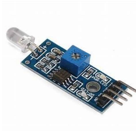
**Gambar 2.6 bentuk photodioda [6]**
