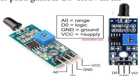
Gambar 2.9 Bentuk fisik dan letak PIN Flame sensor
