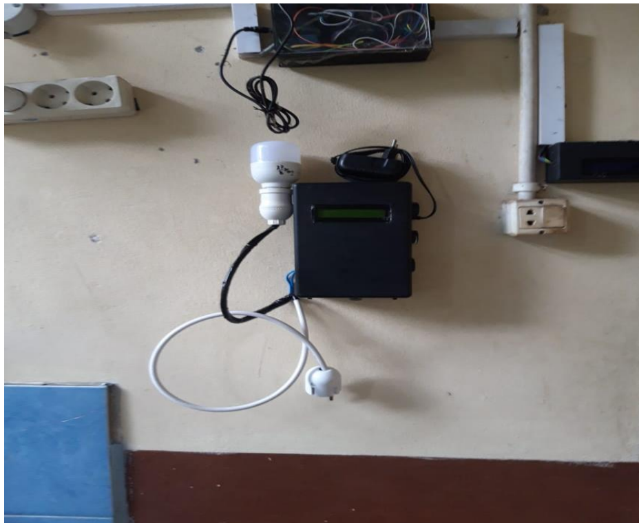
Posisi Penempatan Alat Pendeteksi kebakaran
