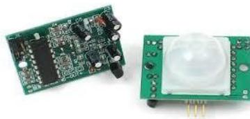
**Gambar 2.3** Komponen Sensor PIR
