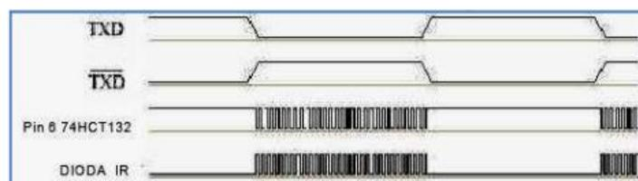
**Gambar 2.16** Bentuk modulasi Infra merah
