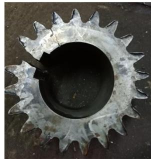
Gambar 2.3 kerusakan pada roda gigi mesin screw press
