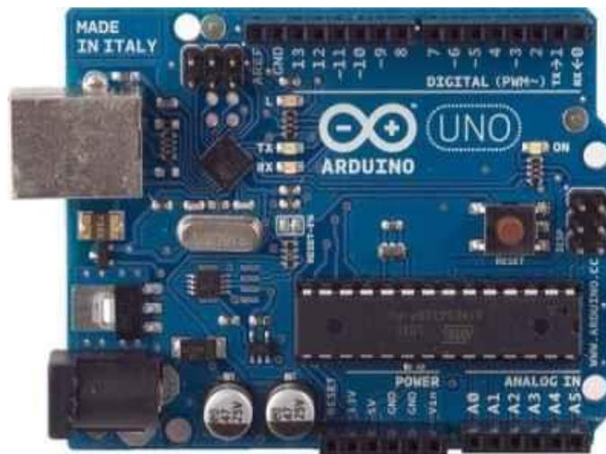
**Gambar 2.10** Bentuk Fisik Arduino Uno
