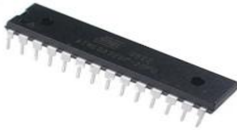
Gambar 2.8 Mikrokontroler AVR ATmega 328
