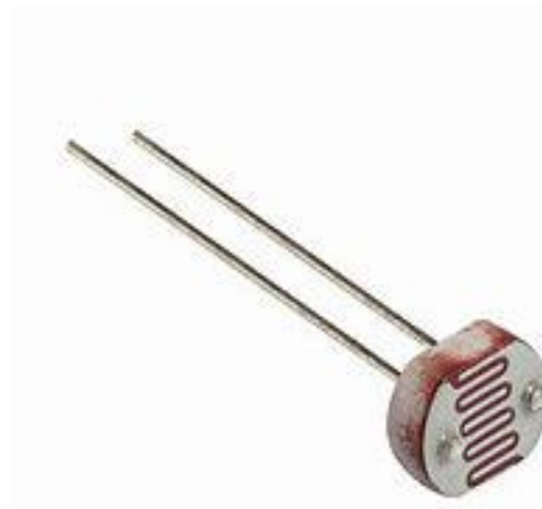
Gambar 2.1 Bentuk LDR ( Light Dependent Resistor )
