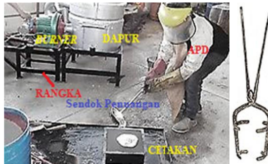
Gambar 2.2 Bagian-Bagian Dapur Cor dan Tang Krusibel (Sumber: Lit. 1, 2018)
