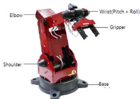
Gambar 2. 3 Struktur Arm Robot Manipulator
