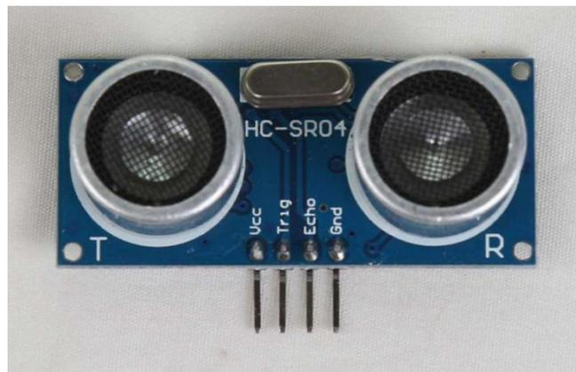
**Gambar 2. 2** Bentuk Fisik Sensor Jarak (*Ultrasonic*)
