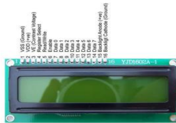
Gambar 2.7 Bentuk Fisik dan Pin LCD 2x16
