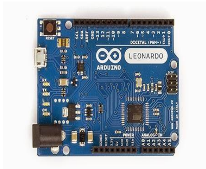
Gambar 2.4 Bentuk Fisik Arduino Leonardo
