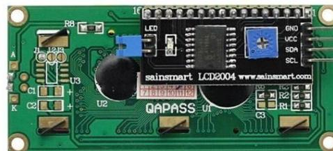
**Gambar 2.4** *Liquid Crystal Display 16x2 dengan modul I2C*
