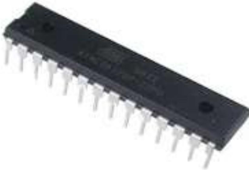
**Gambar 2.6.** Mikrokontroler Atmega328
