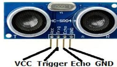
**Gambar 2.5** Konfigurasi Pin dan Tampilan Sensor Ultrasonik HC-SR04
