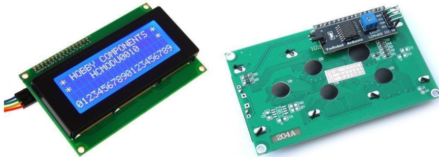
Gambar 2.24 LCD Character Display 20x4 dengan modul I2C
