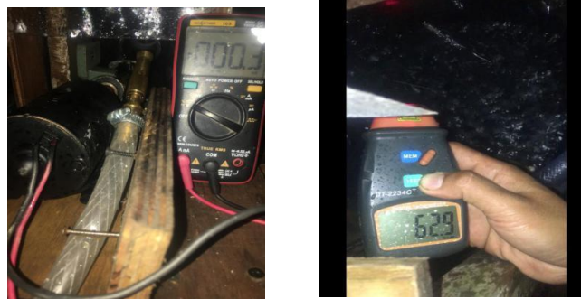
Gambar 4.1 Prosedur Pengukuran Menggunakan Multimeter dan Tachomete
