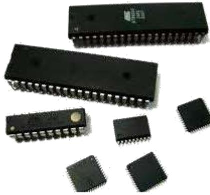
**Gambar 2.8** *Chip Mikrokontroler*
