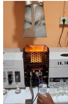
Proses analisis kandungan awal fe pada sampel air tanah dengan Multimeter Digital , dan Atomic Absorption Spectrophotometry
