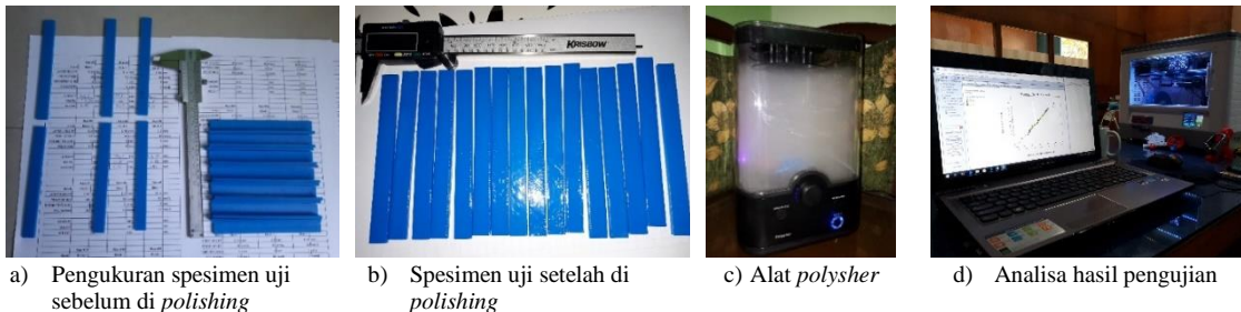
Gambar 3. Pengukuran spesimen uji, alat polishing dan 3D printer
