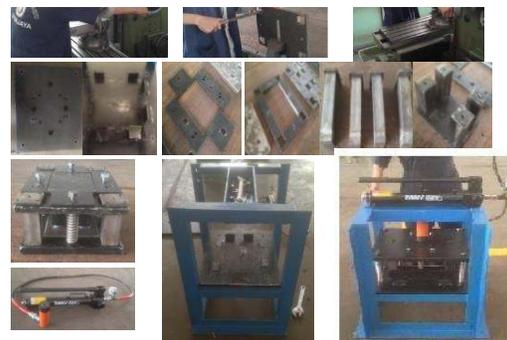
Gambar 15. Proses Pembuatan *Press Tool*
