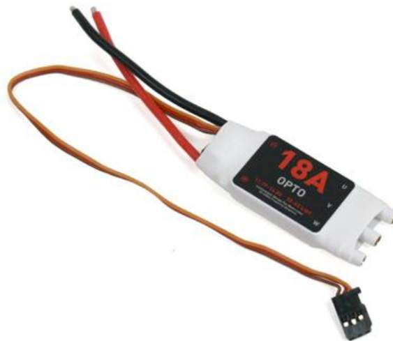
Gambar 2.12 Contoh Bentuk Fisik ESC. (Sumber : www.heliproz.com )
