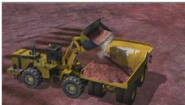
Gambar 2.5 Wheel Loader pada Posisi L Loading Sumber: lit. 6
