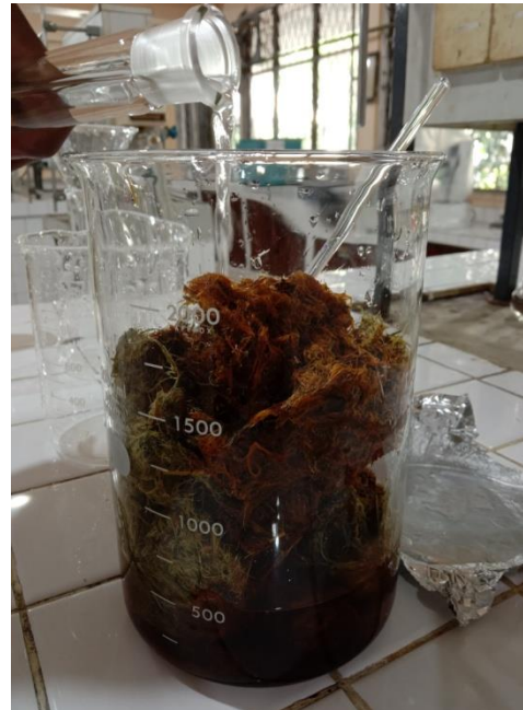
Gambar 12. Menambahkan \text{NaOH} dan \text{Na}_2\text{SO}_3
