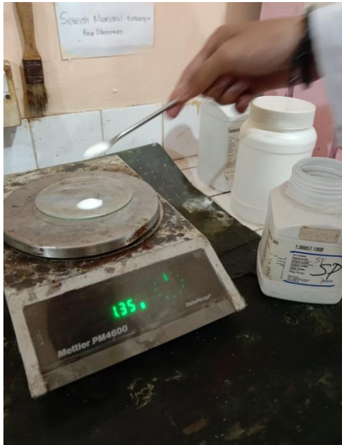
Gambar 11. Menimbang \text{NaOH} dan \text{Na}_2\text{SO}_3
