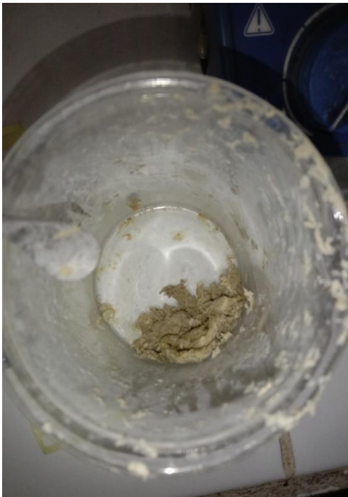
Gambar 27. Memisahkan komposit zeolite-selulosa dari pelarutnya dengan cara menguapkannya.
