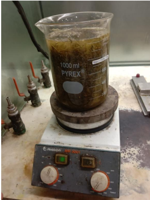
Gambar 9. Menambahkan \text{HNO}_3 dan \text{NaNO}_2 dan memanaskannya selama 2 jam.
