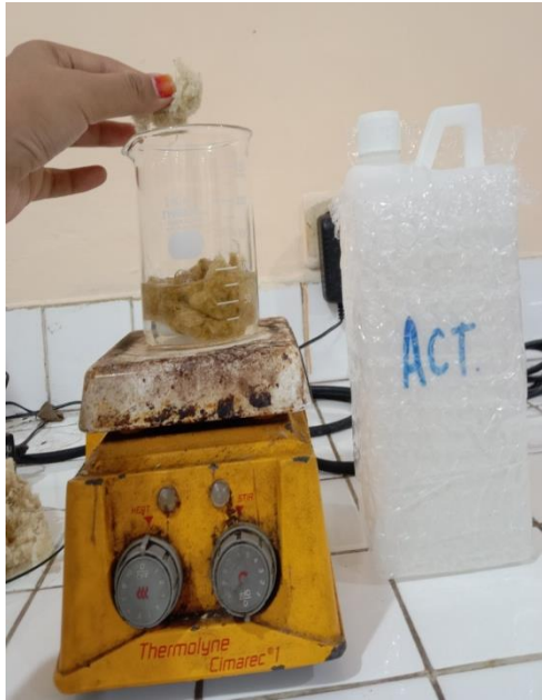
Gambar 25. Melarutkannya dalam 90 mL aceton lalu mengaduknya.
