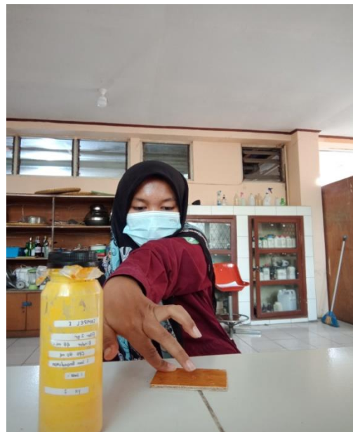
Gambar 36. Proses Uji Waktu Sentuh Kasar Cat Lateks
