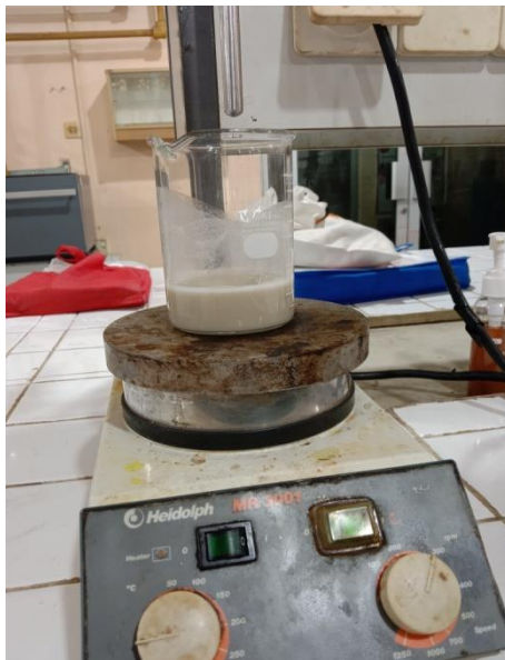
Gambar 20. Mengaduk campuran zeolite dan HCl selama 1 jam dan mengeringkannya pada suhu 300°C selama 3 jam.
