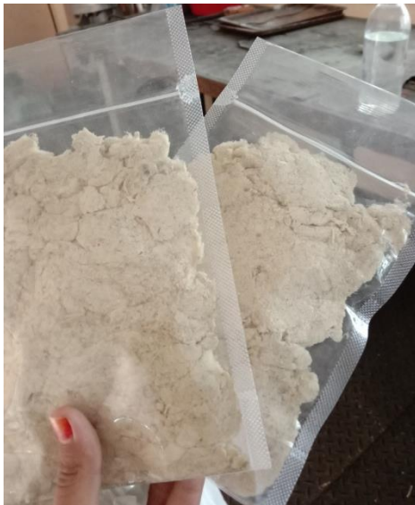
Gambar 23. Serat daun nanas yang sudah dihaluskan.
