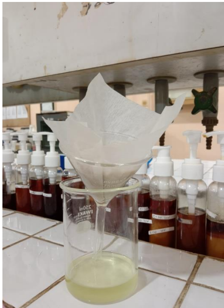
Gambar 7. Mencuci zeolite dengan aquadest, mengeringkannya selama 6 jam dan menimbang zeolite
