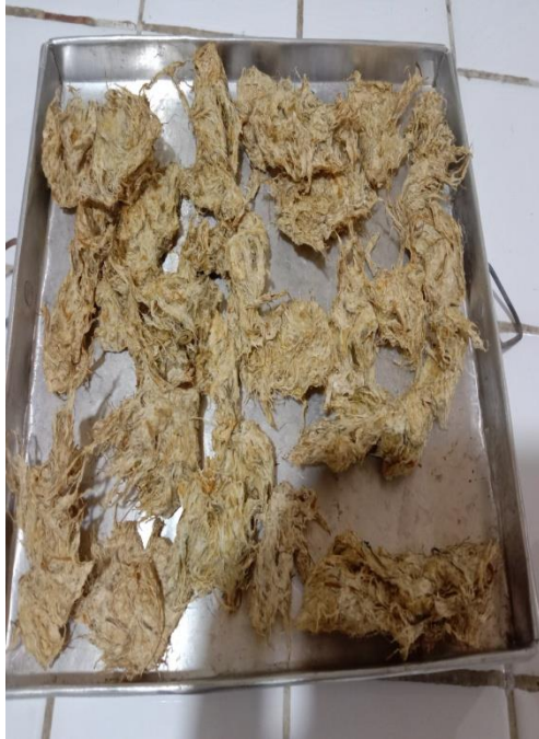
Gambar 17. Perubahan bentuk setelah mem- bleaching dan mengoven serat daun nanas
