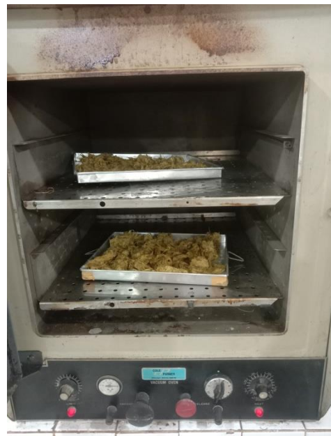
Gambar 16. Mengeringkan dalam oven selama 24 jam pada suhu 60°C.
