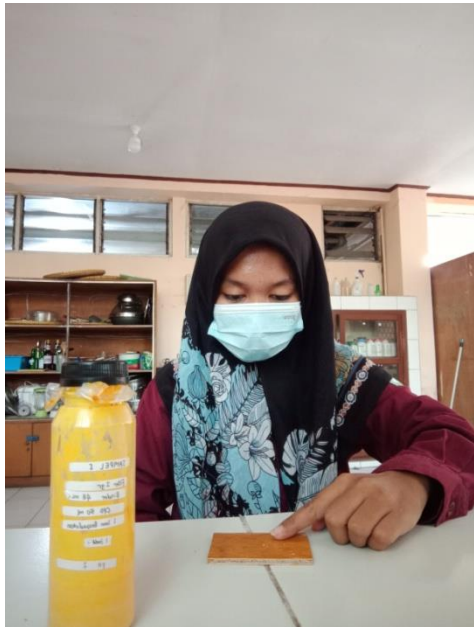
Gambar 35. Proses Uji Waktu Sentuh Kering Cat Lateks
