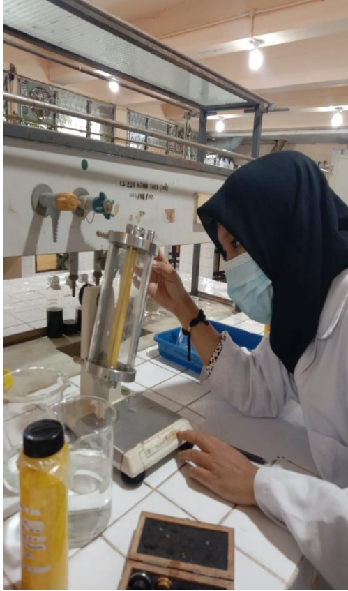
Gambar 33. Proses uji viskositas cat lateks.
