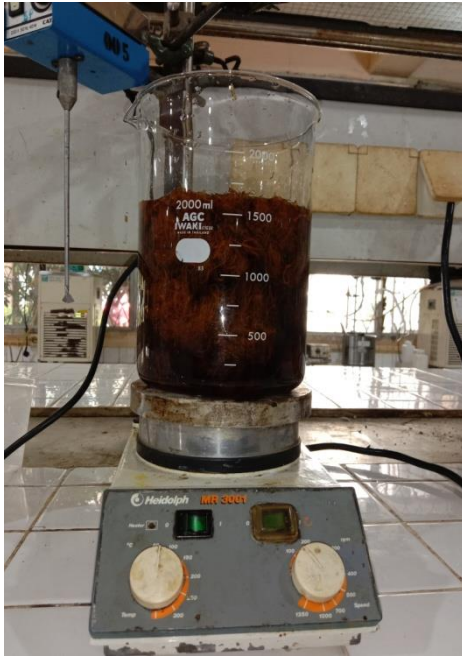
Gambar 13. Memanaskannya pada suhu 50°C selama 1 jam. kemudian memisahkan residunya.
