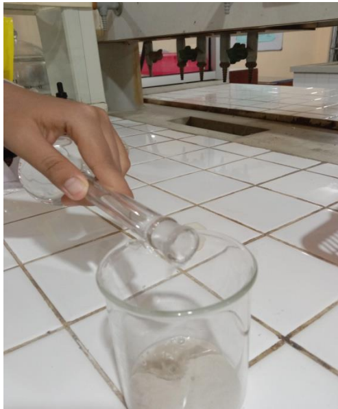
Gambar 19. Menambahkan HCl ke dalam zeolite.
