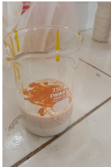
Gambar 28. Mencampurkan filler , binder dan CPO sesuai dengan komposisinya masing-masing.
