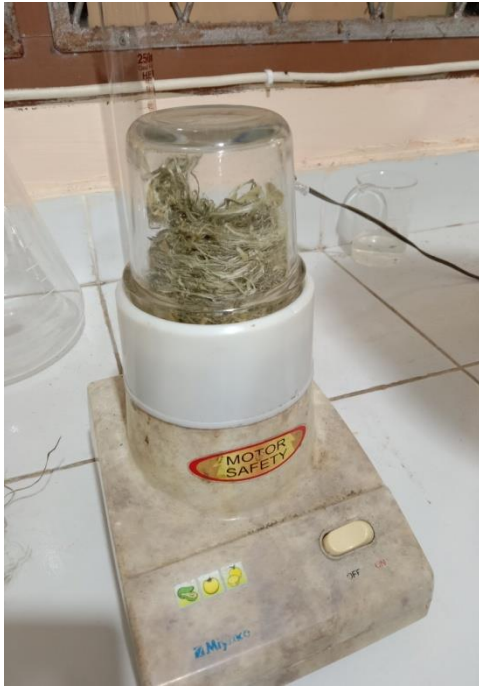
Gambar 21. Mem-blender serat daun nanas sampe halus.
