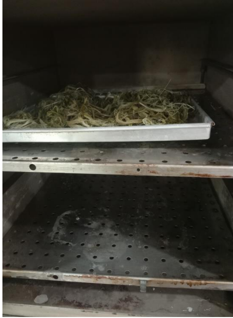
Gambar 5. Mengeringkan serat daun nanas ke dalam oven selama 12 jam pada suhu 100°C
