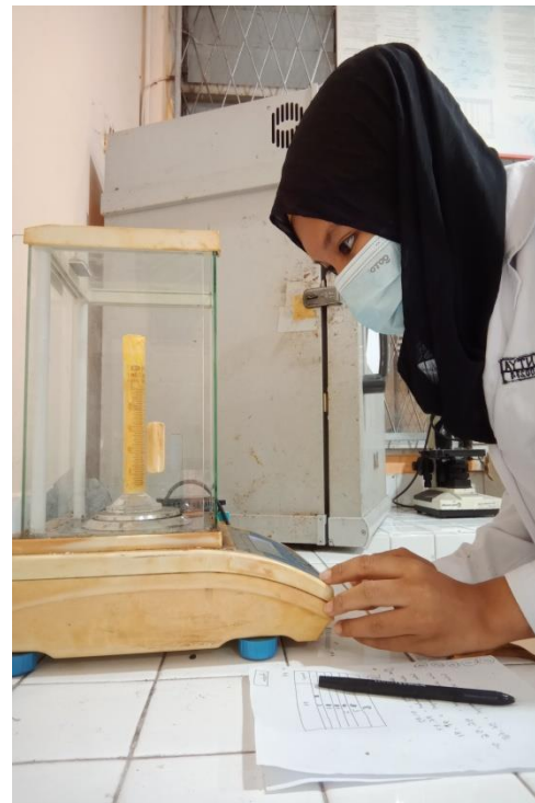
Gambar 32. Proses uji densitas cat lateks
