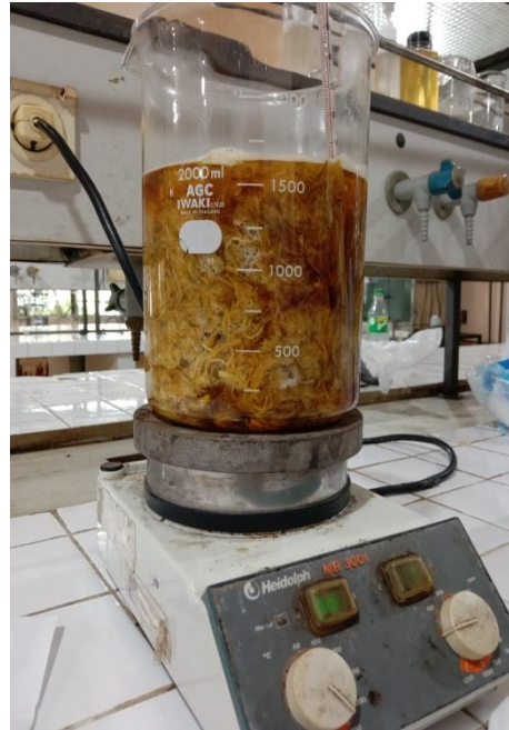
Gambar 14. mem-bleaching sampel dengan NaOCl selama 30 menit dengan temperature mendidih
