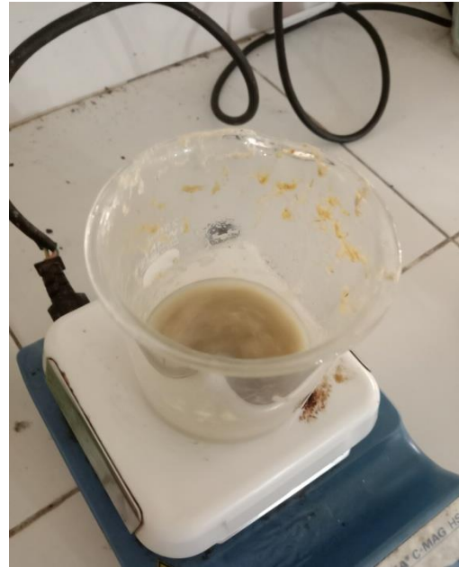
Gambar 26. Menambahkan 1gr zeolite dan mengaduknya hingga homogen
