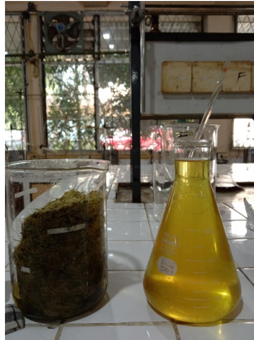
Gambar 10. Memisahkan filtrat dan residu serat daun nanas.
