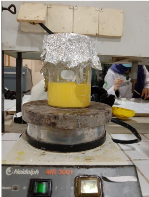
Gambar 29. Mengaduk semua bahan pembuatan cat lateks dengan 1 jam pengadukan.
