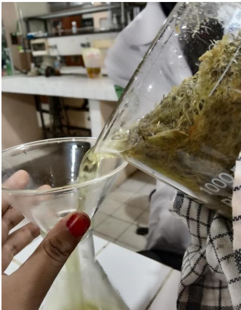
Gambar 15. Menyaring lagi campurannya, residunya dicuci sampai pH filtrat menjadi netral.
