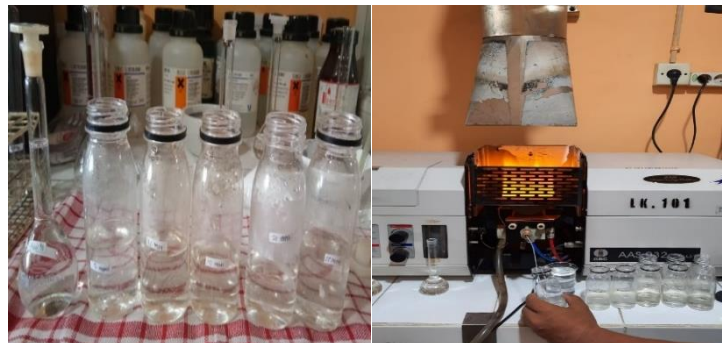
Gambar C.15 Analisis kadar Fe dalam limbah cair setelah dilakukan proses adsorpsi menggunakan alat Atomic Absorption Spectrophotometer (AAS)
