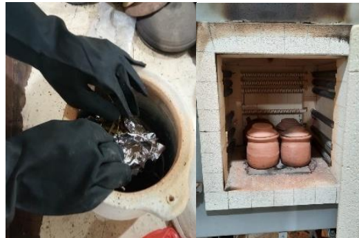
Gambar C.3 Bahan baku dimasukkan ke dalam kendi dan dikarbonisasi dalam furnace pada suhu 350°C selama 30 menit
