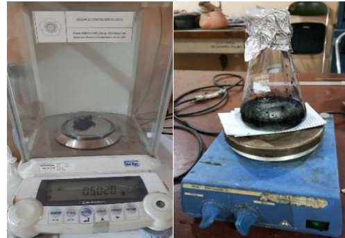
Gambar C.14 Proses pengontakkan karbon aktif ke dalam limbah Fe
