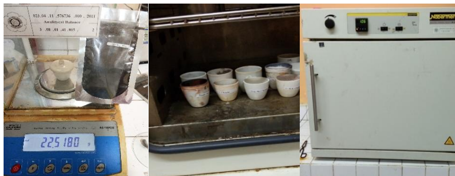
Gambar C.9 Analisis kadar air (Karbon Aktif dioven pada suhu 105^{\circ}\text{C} selama 1 jam)
