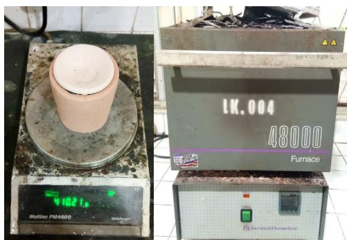
Gambar C.10 Analisis kadar abu (Karbon aktif dimasukkan ke furnace pada suhu 650^{\circ}\text{C} selama 4 jam)
