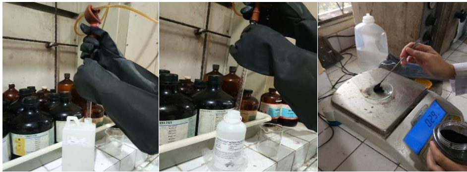
Gambar C.7 Proses aktivasi karbon dengan direndam dalam larutan aktivator HCl dan H_3PO_4 selama 24 jam
